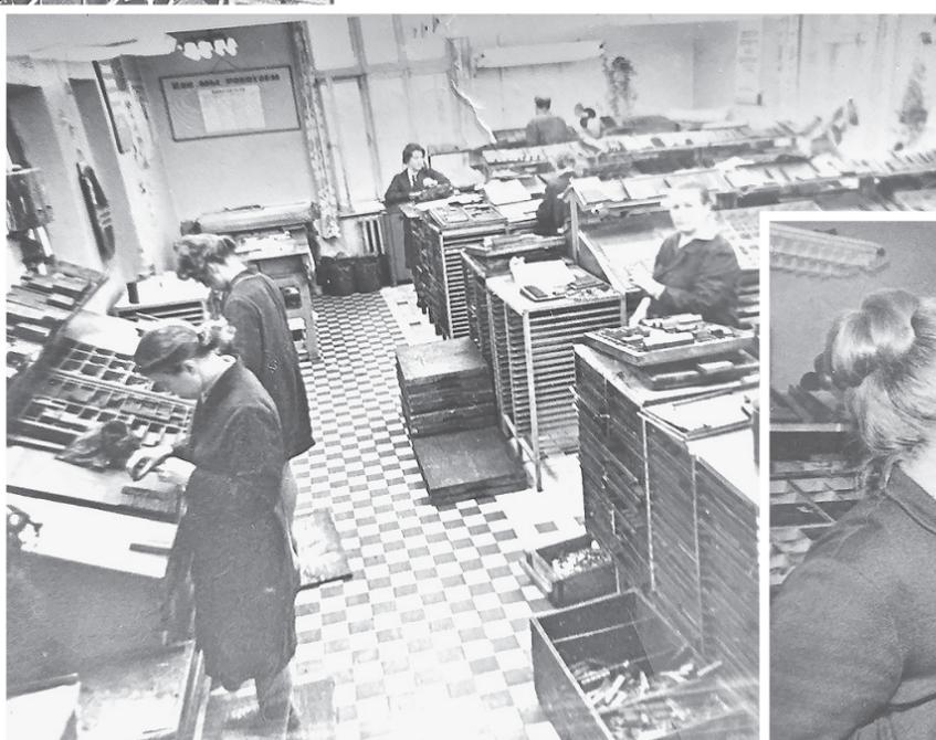
📍 Цех ручного набора. Наборщицы работают всю смену стоя, работа грязная, ведь на шрифтах остается краска после печати. У дальней стены цеха Л.А. Ефимов верстает «Лужскую правду». Слева на заднем плане тискальный станок, куда относились на верстаках сверстаные газетные полосы и бланковская продукция.
