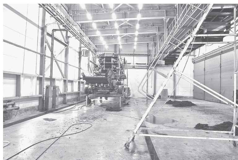
■ После зоны смешивания компост поступает в тоннель фазы-2, где происходит его пастеризация – убиваются все патогены
