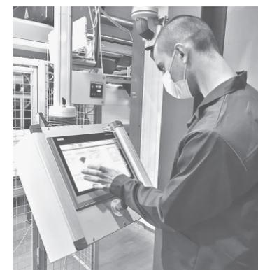
Оператор контролирует изготовление шлифовальной шкурки
